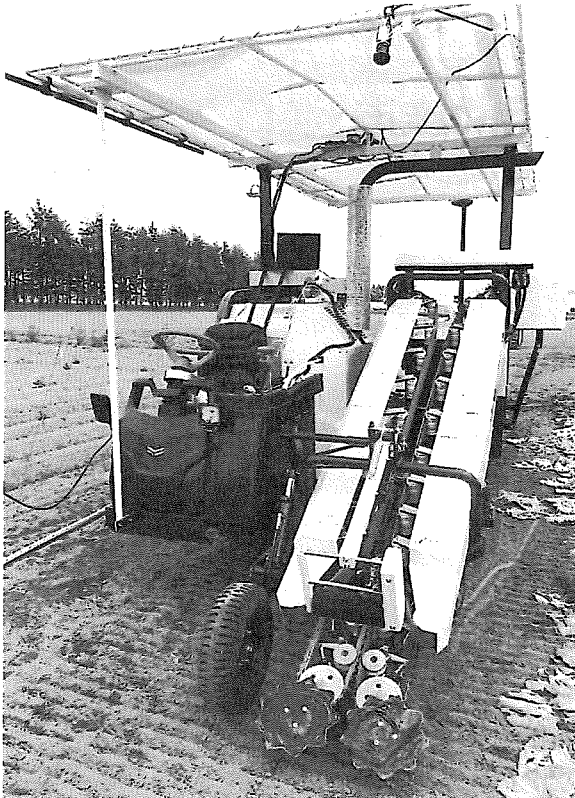
キャベツの自動収穫機。屋根前方のカメラの映像から、AIが球を判別する(立命館大学提供)
