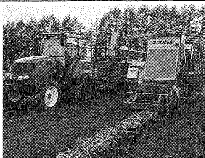
自動収穫するオニオンピッカーと自動トラクタが並走
