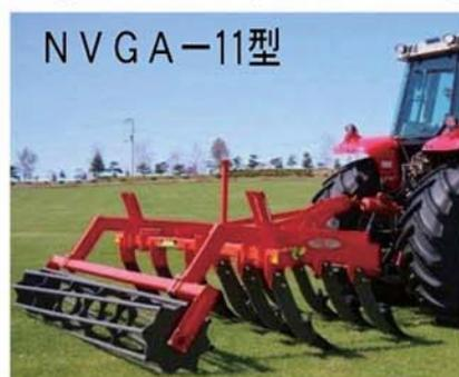
ソイルクランブラは簡易粗耕起を4~8km/hの高速で行うことができます。弊社オリジナルのナイフ、刃先の角度形状により、下層部の土を極端に持ち上げることがないため、耕起後の圃場に急激な変化を与えません。
