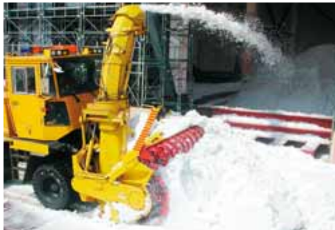
Stocking the snow room: the International Media Center at the G8 Hokkaido Toyako Summit 2008年北海道洞爺湖サミット国際メディアセンター 雪室への雪搬入状況
