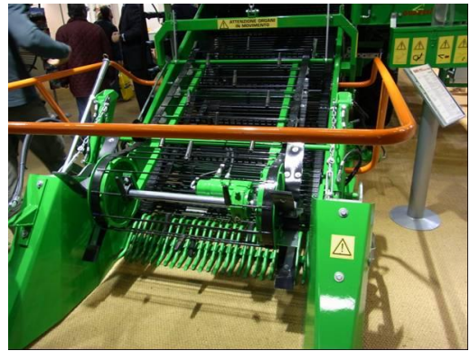
図 3-8 トマトハーベスタの拾い上げ部 (くし歯の裏に切断用レシプロ刃)
