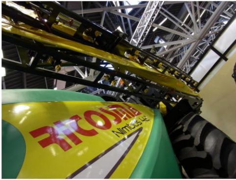
図 3-13 エアーアシストブーム (エアーダクトが小型化)
