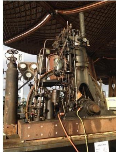
図 16 Rudolf Diesel 展示 (MAN 社製, 20PS ディーゼルエンジン)
