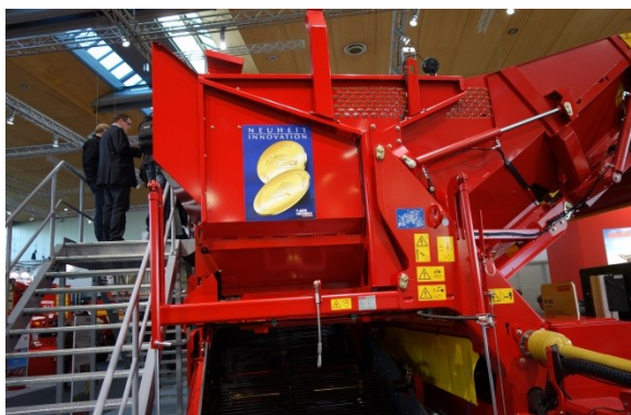
図 6 空気気流による石礫選別装置付ポテトハーベスタ
