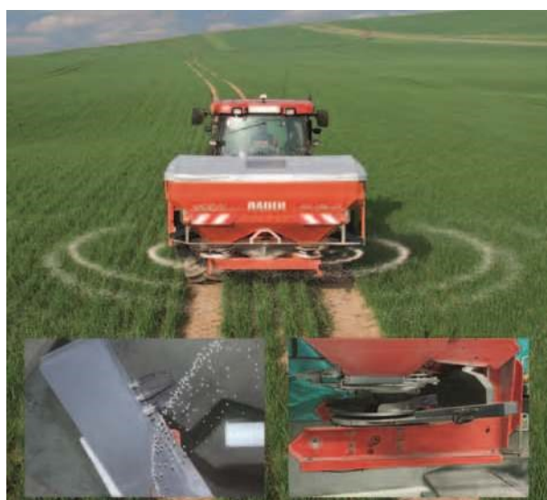
図 7 超音波による散布幅計測のブロードキャスタ
